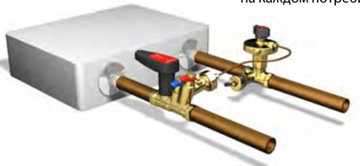
При использовании в сочетании с клапаном BALLOREX® Venturi в качестве клапана партнера, капиллярная трубка подключается к клапану BALLOREX® Venturi установленному на подающей линии. Будучи предустановленным на заданное значение перепада давления в соответствии с вышеуказанными значениями, расчетное значение расхода может быть легко
